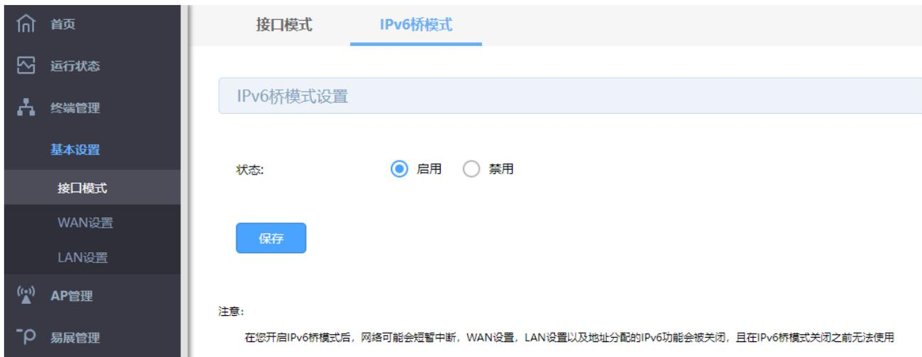
2. 开启桥模式后 WAN 口和 LAN 口的 IPv6 参数均不可设置。进入页面“基本设置 >> WAN 设置”，在页面上方选择 WAN 口，禁用 WAN 口的 IPv6 功能；进入页面“基本设置 >> LAN 设置 >> LAN 设置”，禁用 LAN 口的 IPv6 功能。
